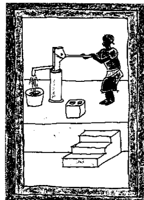
Bomba manual sobre aterro
