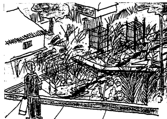
Drenagem sem manutenção
